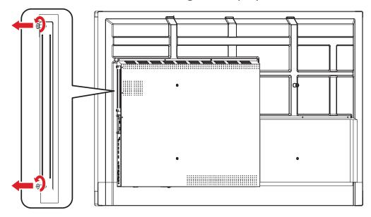
**2.** Setzen Sie den VPCF5-2A vorsichtig durch Halten am Griff in den PC-Steckplatz des Displays ein.
