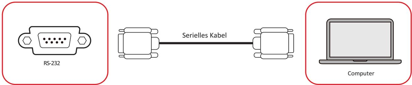
Wenn Sie Ihr Display über ein serielles RS-232-Kabel mit einem externen Computer verbinden, können Sie bestimmte Funktionen per PC fernsteuern – beispielsweise Ein-/Aus-switchen, Lautstärkeregelung, Eingangsauswahl, Helligkeit und mehr.
