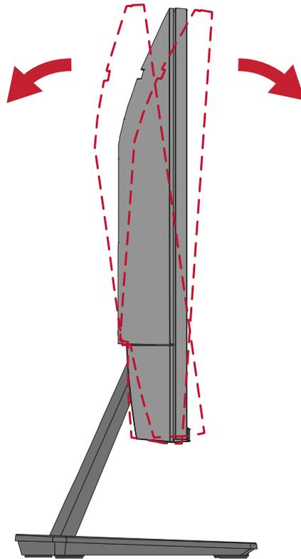
**Hinweis:** Stützen Sie den Ständer beim Anpassen sicher mit einer Hand, während Sie den Monitor mit der anderen Hand nach vorne oder hinten neigen.
