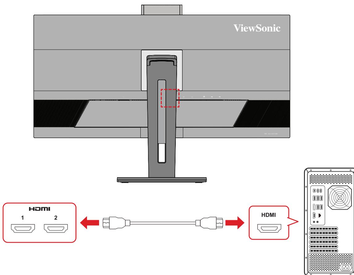
1. Conecte un extremo de un cable HDMI al puerto HDMI del monitor.
