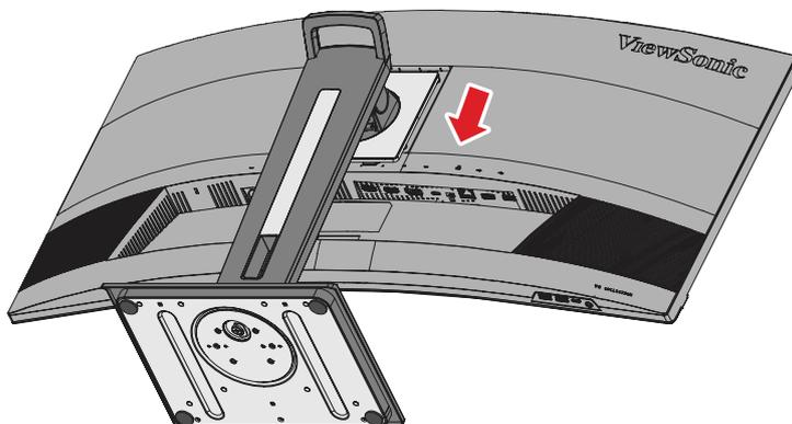
5. Atornille el soporte de montaje en los orificios de instalación VESA situados en la parte posterior del dispositivo. A continuación, fíjelo con cuatro (4) tornillos (M4 x 10 mm).
