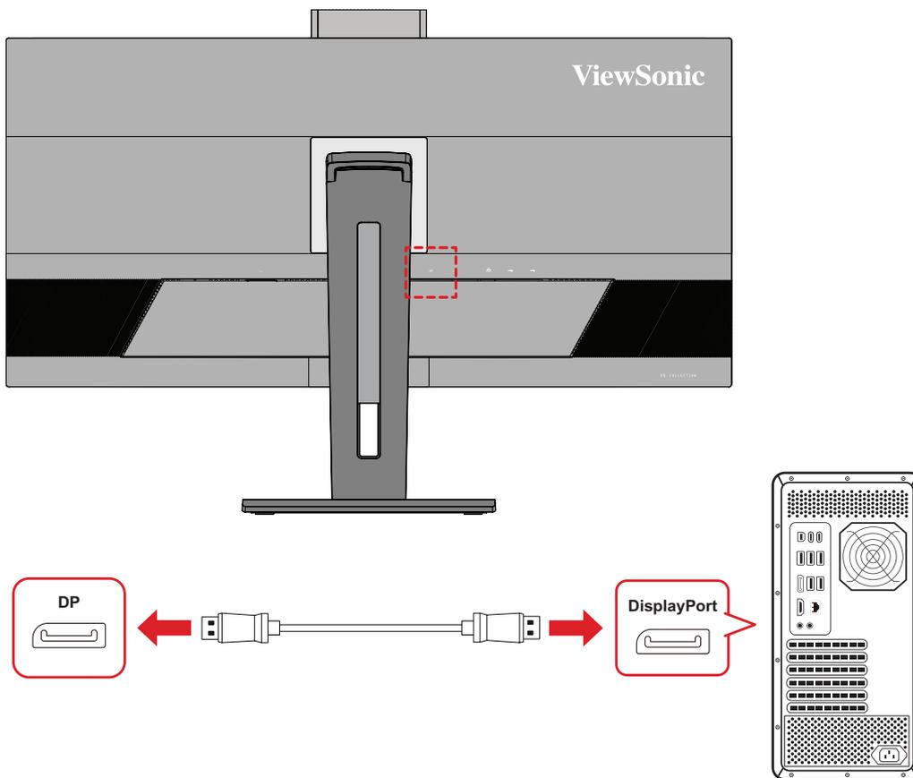
1. Conecte un extremo de un cable DisplayPort al puerto DisplayPort o mini-DP.
