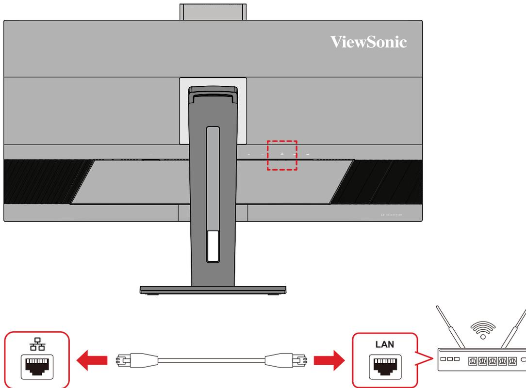
1. Conecte un extremo de su cable LAN (RJ45) al puerto LAN (RJ45) del monitor.
