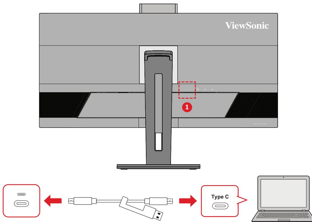
1. Conecte el extremo de un cable USB tipo C al puerto USB tipo C ascendente posterior ( **1** ) del monitor.
