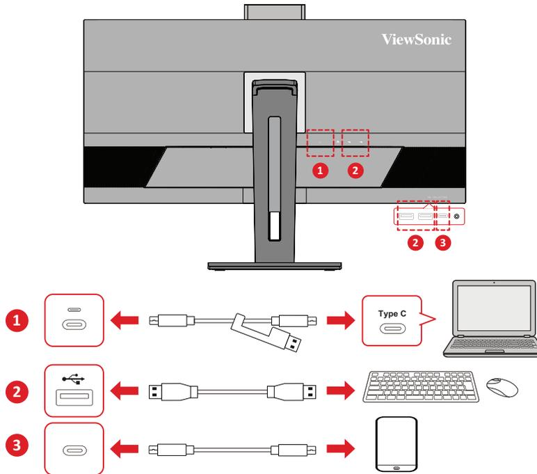
**NOTA:** Si necesita conectarse a través de HDMI o DisplayPort, utilice también un cable USB de tipo C a USB de tipo A para conectarse al monitor y permitir la transferencia de datos.
