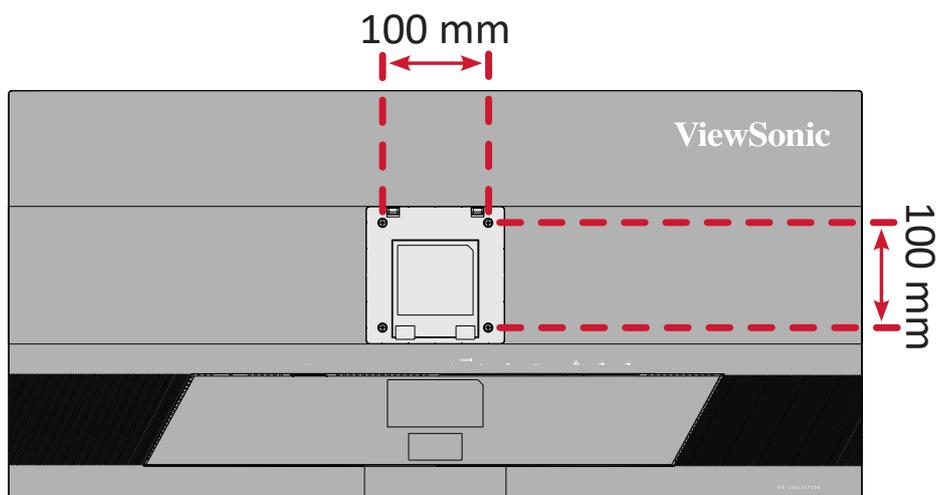
6. Siga las instrucciones incluidas con el kit de instalación en pared para montar el monitor en la pared.
