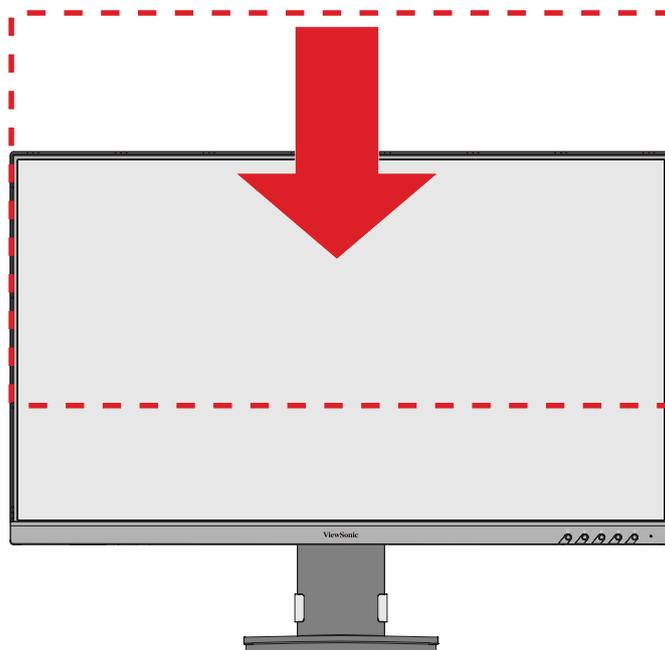
**NOTA:** Quando ajustar o monitor, pressione firmemente ao longo da calha de ajuste segurando o monitor com ambas as mãos na parte lateral.
