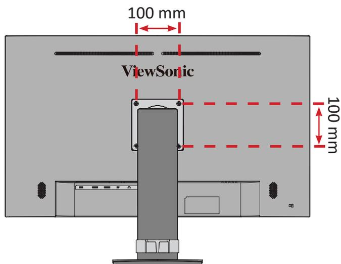
5. Siga as instruções fornecidas com o kit de montagem na parede para montar o monitor na parede.
