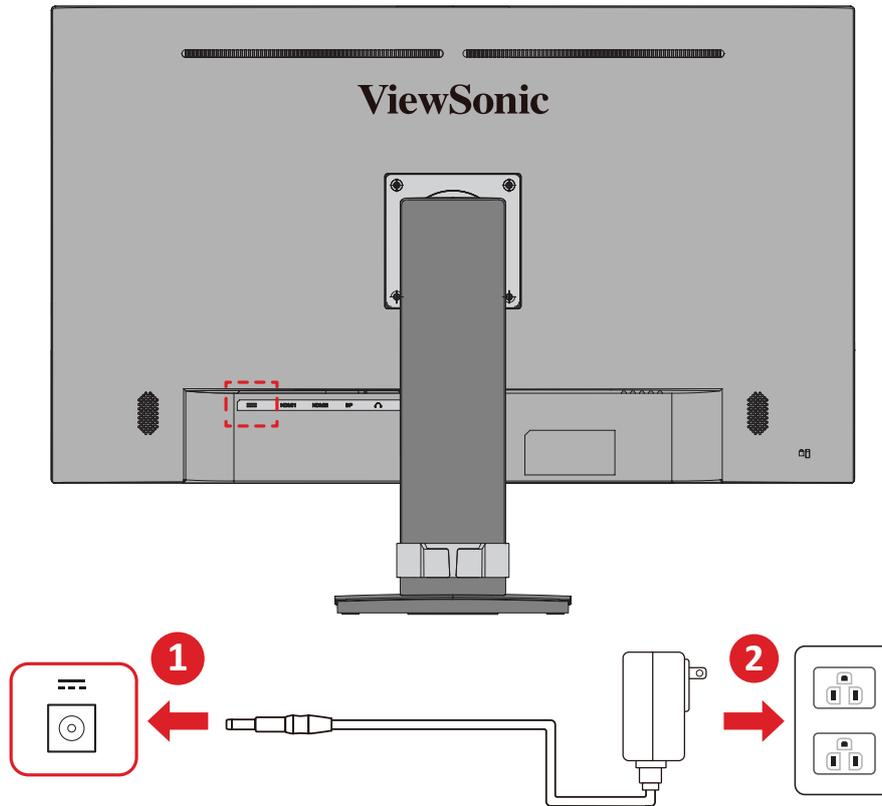
1. Ligue o transformador à tomada de entrada DC na traseira do dispositivo.
