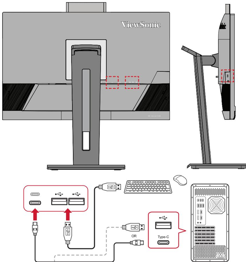
**CATATAN:** Jika perangkat Anda dilengkapi dengan port USB Tipe C, Anda dapat langsung menyambungkan ke monitor dengan kabel USB Tipe C ke USB Tipe C. Jika Anda perlu menyambungkan melalui HDMI atau DP ke monitor, gunakan juga kabel USB Tipe C ke USB Tipe A untuk menyambungkan ke monitor guna mengaktifkan transmisi data.
