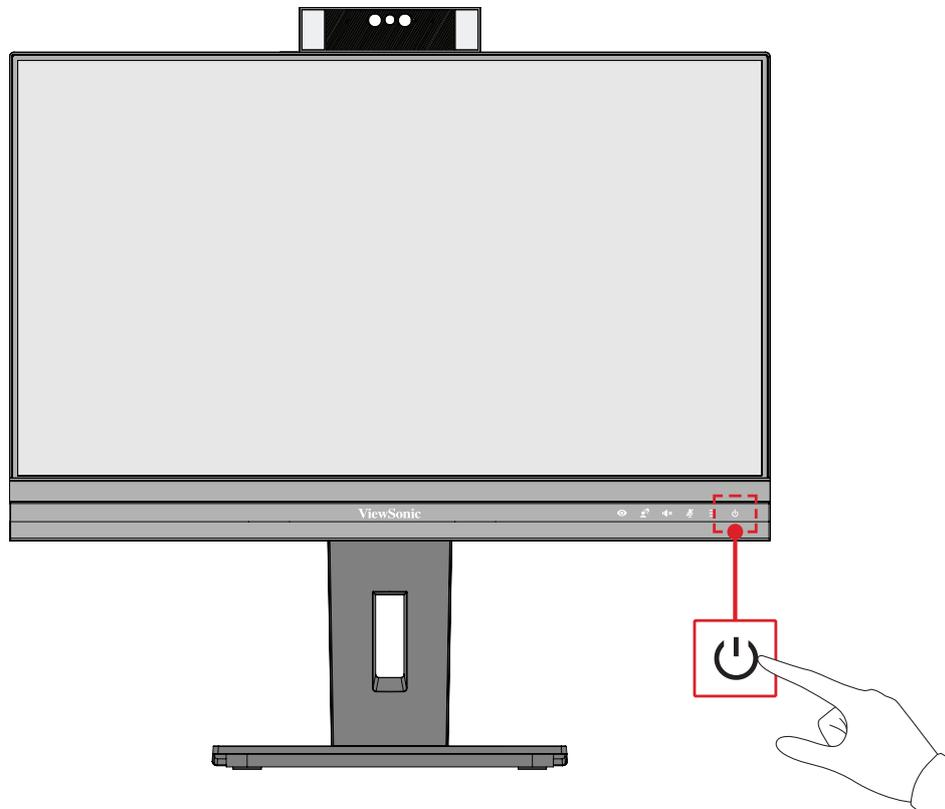
**CATATAN:** Monitor masih akan menggunakan daya selama kabel daya tersambung ke stopkontak. Jika monitor tidak digunakan untuk waktu lama, putuskan sambungan konektor daya dari stopkontak.
