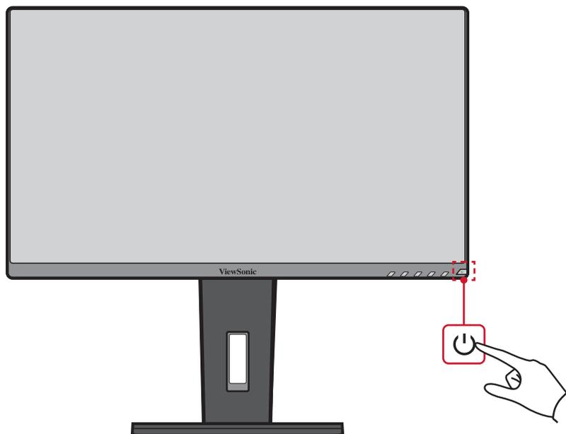
**ПРИМЕЧАНИЕ.** Если шнур питания подключен к электрической розетке, выключенный монитор будет потреблять некоторое количество энергии. Если монитор не будет использоваться длительное время, отсоедините вилку питания от электрической розетки.
