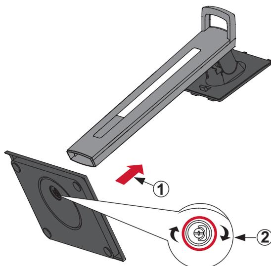
4. Выровняйте и вставьте верхние фиксаторы подставки монитора в разъемы для установки, как показано на рисунке ниже:
