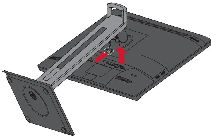
4. Слегка потяните ее вниз, чтобы отсоединить фиксаторы и снять подставку.
