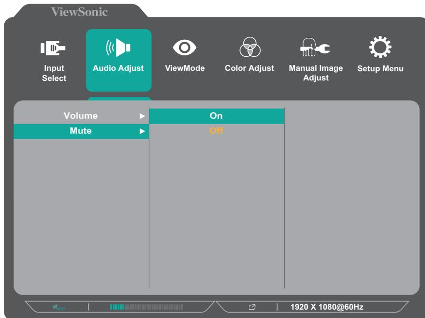
4. Presione el botón **1(ViewMode)** o **2** para ajustar o seleccionar la configuración. A continuación, presione el botón **3** para confirmar.
