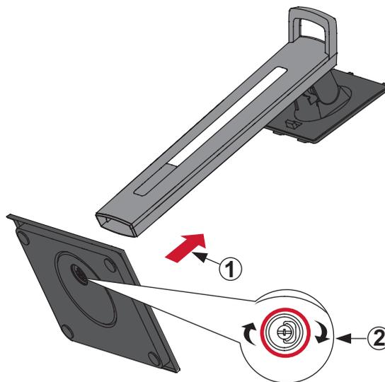
4. Alinee y deslice los ganchos superiores del pedestal del monitor en las ranuras de montaje de dicho pedestal, tal y como se muestra en la siguiente ilustración:
