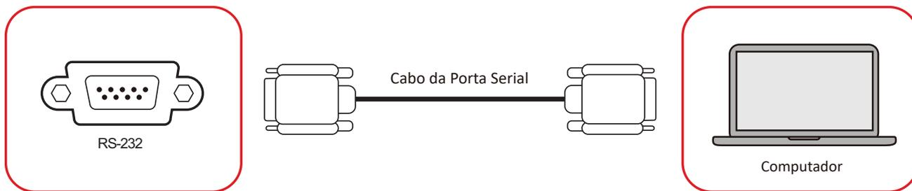
Quando você usa um cabo com porta serial RS-232 para conectar seu monitor a um computador externo, certas funções podem ser controladas de modo remoto pelo PC, incluindo Liga/ Desliga Energia, ajuste de Volume, selecionar Entrada, Brilho e mais.
