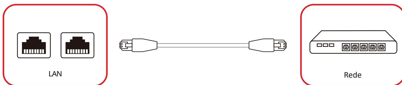
Para conectar-se a uma rede local, conecte um cabo Ethernet à sua rede e, em seguida, conecte a outra extremidade a uma porta **LAN** do monitor.
