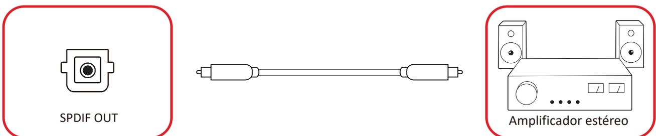
Para conectar a um sistema de som externo, conecte um cabo óptico da porta **SPDIF** do monitor ao conector óptico do sistema de som.
