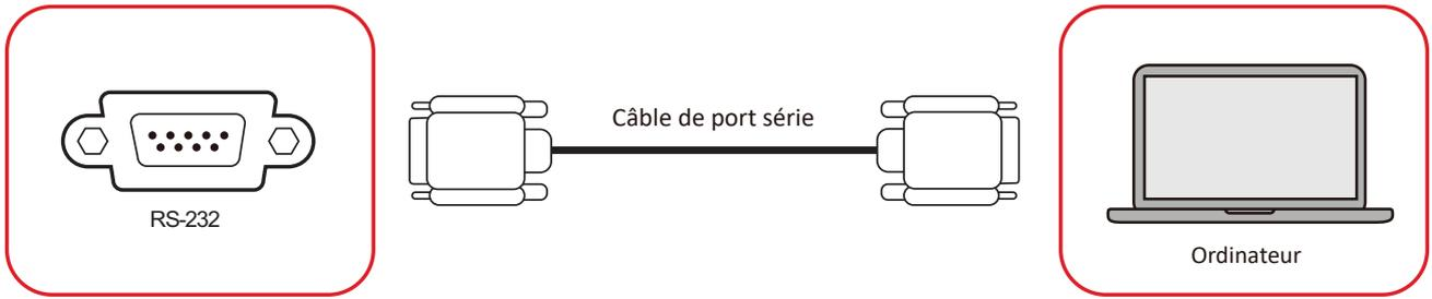
Lorsque vous utilisez un câble de port série RS-232 pour connecter votre écran à un ordinateur externe, certaines fonctions peuvent être contrôlées à distance par le PC, y compris la mise sous tension/hors tension, le réglage du volume, la sélection de l'entrée, la luminosité, etc.
