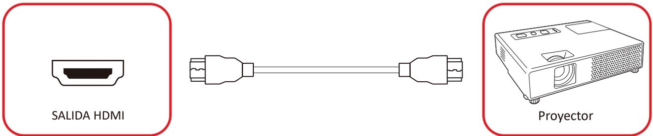
Para transmitir vídeo a través de un dispositivo de visualización:
