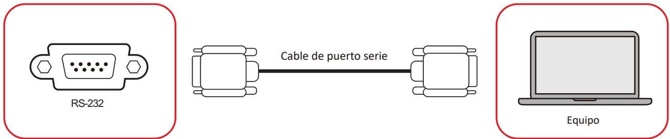
Cuando utilice un cable de puerto serie RS-232 para conectar la pantalla a un equipo externo, determinadas funciones se pueden controlar remotamente mediante el equipo, como el ENCENDIDO y APAGADO de la alimentación, el ajuste del volumen, la selección de entrada, el brillo, etc.
