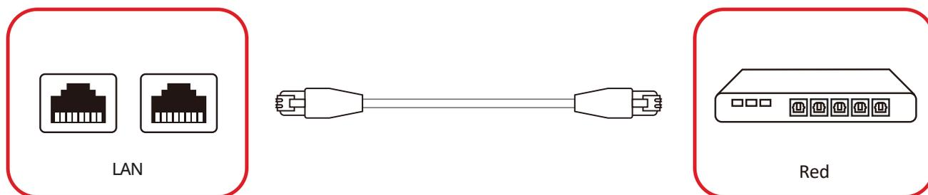
Para conectarse a una red local, conecte un cable Ethernet a la red y, a continuación, conecte el otro extremo a un **LAN** puerto de la pantalla.
