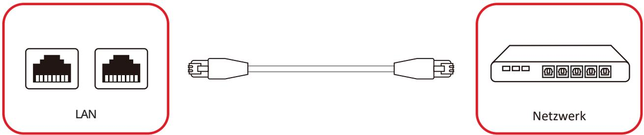
Um sich mit einem lokalen Netzwerk zu verbinden, schließen Sie ein Ethernet-Kabel an Ihr Netzwerk an und verbinden Sie das andere Ende mit einem **LAN** Anschluss des Displays.
