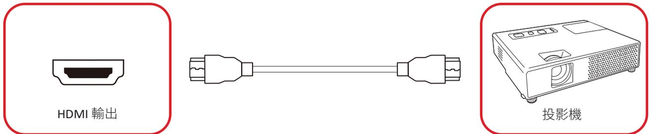
若要透過外部顯示裝置輸出視訊，請將 HDMI 線連接至外部顯示裝置的 **HDMI 輸入** 連接埠，另一端連接至顯示器的 **HDMI 輸出** 連接埠。
