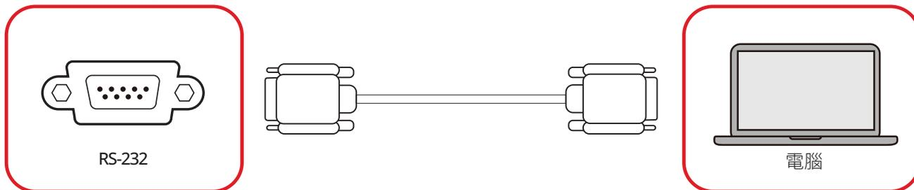
使用 RS-232 序列線將顯示器連接至外部電腦或控制系統時，可遠端控制某些功能，例如：電源開啟和關閉、音量調整、輸入選擇、亮度等。
