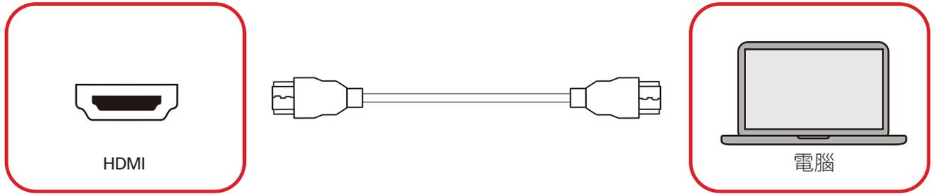
將 HDMI 線從外部裝置連接到顯示器上的 **HDMI 1/HDMI 2/HDMI 3/ HDMI 4** 連接埠。
