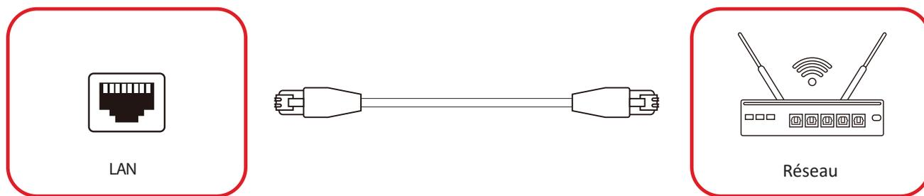
Pour vous connecter à un réseau, connectez un câble Ethernet à votre réseau, puis branchez l'autre extrémité dans le port **LAN** de l'écran.
