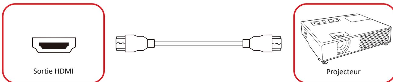
Pour générer la vidéo via un dispositif d'affichage externe, connectez un câble HDMI au port **ENTRÉE HDMI** de votre dispositif d'affichage externe et l'autre extrémité au port **SORTIE HDMI** de l'écran.
