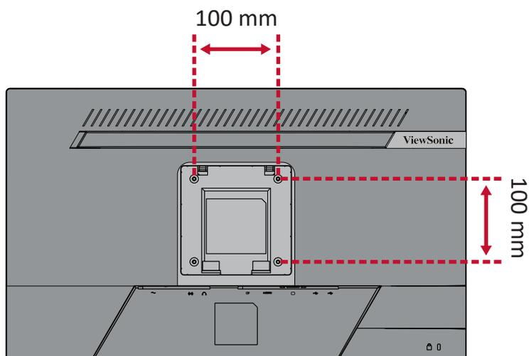
6. 按照壁装套件随附的说明书将显示器安装在墙壁上。
