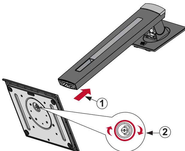
4. 将底座上方的卡钩与显示器底座安装槽对齐并滑入安装槽中，如下图所示：
