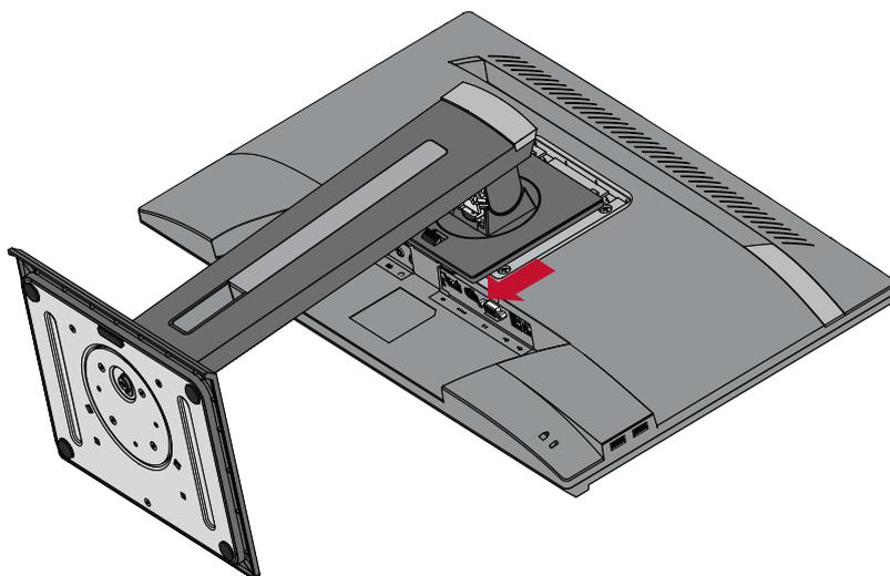
5. 将安装支架连接到设备后部的 VESA 安装孔。
