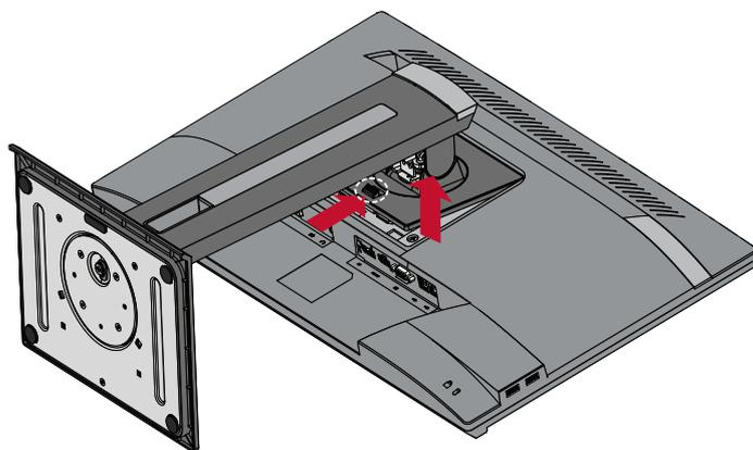
4. 轻轻地向下拉动卡钩，使其脱离安装槽，然后拆下底座。
