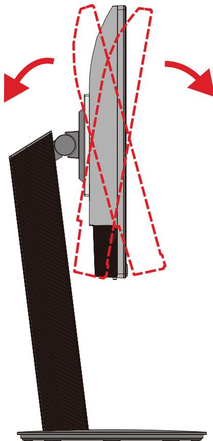
**NOTA:** Quando ajustar o monitor, segure firmemente no suporte com uma mão e incline o monitor para a frente ou para trás com a outra mão.
