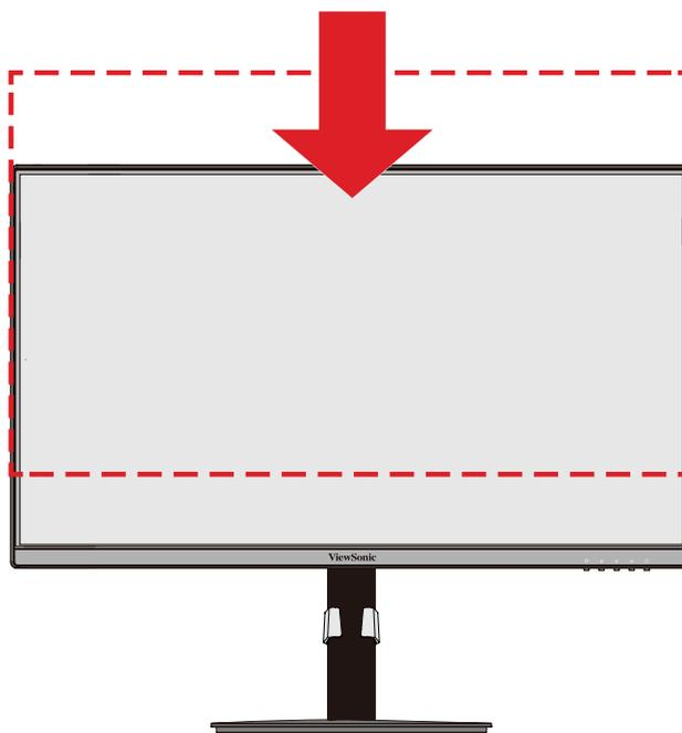
**NOTA:** Quando ajustar o monitor, pressione firmemente ao longo da calha de ajuste segurando o monitor com ambas as mãos na parte lateral.
