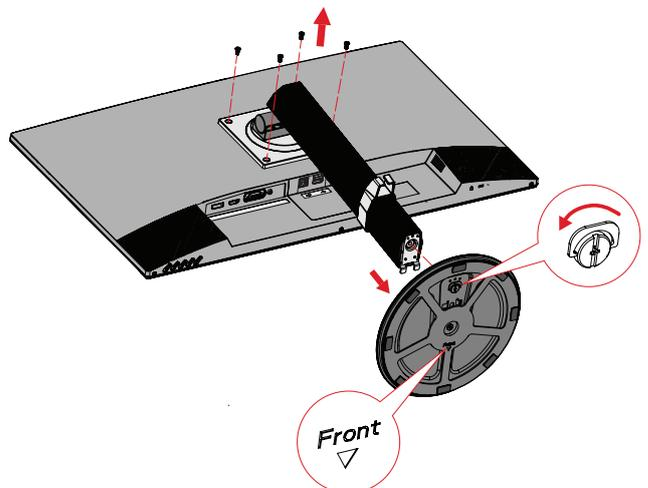
4. Coloque o suporte de montagem sobre os orifícios de montagem VESA na traseira do dispositivo. Em seguida, fixe-o com quatro (4) parafusos (M4 x 10 mm).
