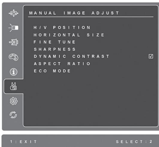
**H/V. Position (Horizontalni/Vertikalni položaj)** pomera sliku na ekranu levo ili desno i gore ili dole.
