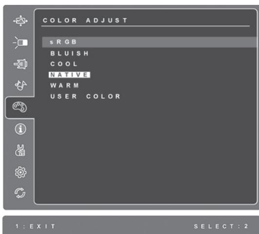
**sRGB**-Ovo ubrzano postaje industrijski standard za upravljanje bojama, uz podršku koja uključena u mnogim najnovijim aplikacijama. Omogućavanje ovog podešavanja dozvoljava LCD ekranu da preciznije prikaže boje na način na koji je to prvobitno nameravano. Omogućavajući sRGB podešavanje doveće do isključivanja podešavanja kontrasta (Contrast) i osvetljenja (Brightness).
