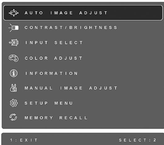
**POZNÁMKA:** Všechny nabídky a okna s nastavením OSD se automaticky po 15 sekundách zavřou. Tento interval lze upravit prostřednictvím nastavení časového limitu rozhraní OSD v nabídce nastavení.
