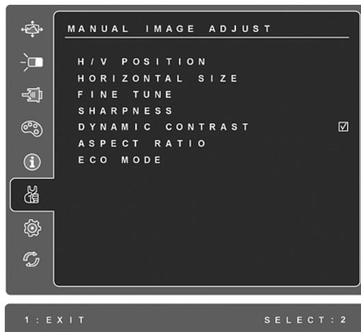
**H.V. Position (Horizontální/vertikální poloha)** posunuje zobrazení na monitoru vlevo, vpravo, nahoru nebo dolů.
