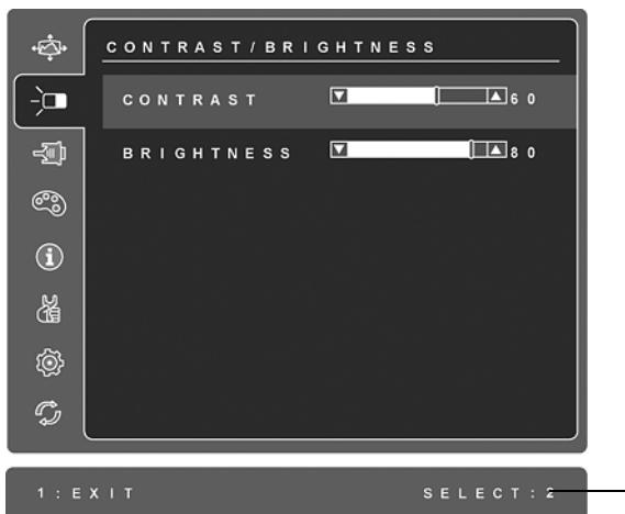
Na řádku v dolní části okna jsou uvedeny další kroky, které lze provést: zavřete okno nebo vyberte ovládací prvek Brightness (Jas).
